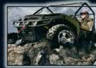
Sportsman 400 HO Le moteur 454 cc HO carbu mis dans un chassis "full size"
